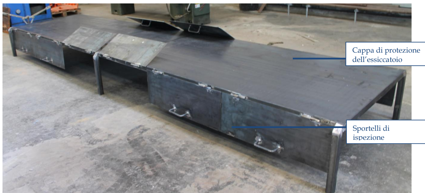
Foto 9.2. Essiccatoio. Particolare della cappa di protezione dell'essiccatoio
