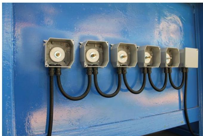
Foto 3.3. Forno di ricottura. Particolare cassette in alluminio per le resistenze.
